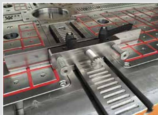
Centrages dédiés en fonction des moules du client
