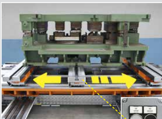
Moteur oléodynamique sous parallèle pour pouvoir déplacer les barres parallèles en appuyant simplement sur un bouton et trouver la position de droite à gauche
