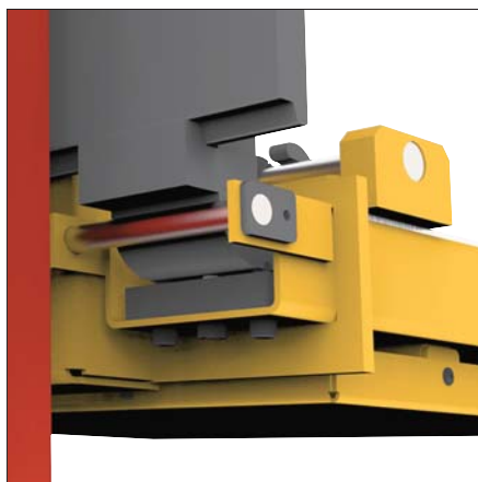
Verrouillage du plateau sur la fourche existante
