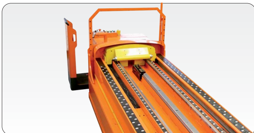
Plateau pour 2 outils à rouleaux escamotables
