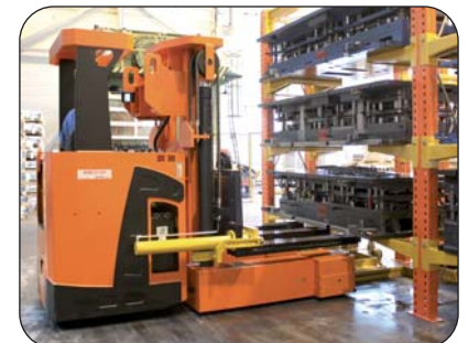
Prise d'un outil en gerbant, sans opération manuelle
