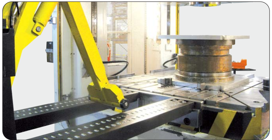
Chargement d'outil sur presse hydraulique 1000 tonnes, équipée de segments à rouleaux TRANSROLLER® Rotobloc-PSP
