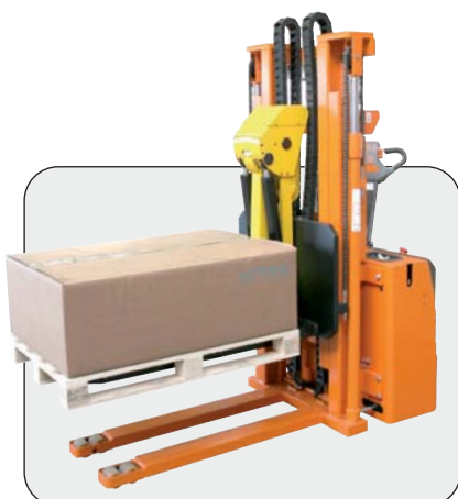
Le chariot garde sa fonction de gerbeur de palette
