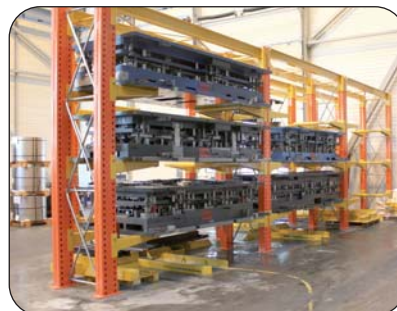
MAXI-CANTIBLOC® capacité total 37,5 tonnes (12,5 tonnes par outil)
