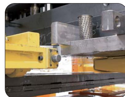
Système d'accrochage à baïonnettes. Accrochage de l'outil en temps masqué dans le rack de stockage.
